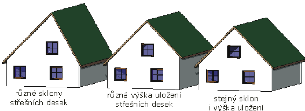
Obrázek 10.3: Různé typy sedlových střech.
