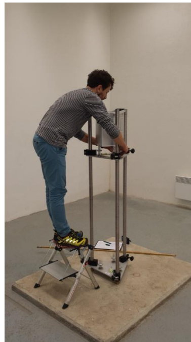
Určování tíhového gradientu přístrojem CG-5
