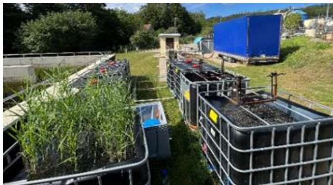
Obrázek 4 In-situ validační testování pokročilých oxidačních technologií na lokalitě ČOV Blansko a přírodě blízké způsoby dočištění.
